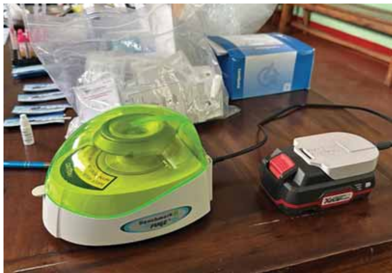
Obr. 2. Centrifuga upravená na napájení z akumulátoru.
